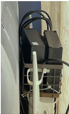
金属カゴを結束バンドでスタンドに固定して、HDDを積載
